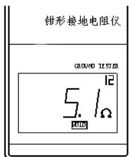
E.长按（超过 3 秒）POWER 按钮，将显示 MEM 符号，仪表进入记忆状态，如左图所示。再短按（不超过 3 秒）POWER 按钮，则退出记忆状态，且将液晶屏上的数据记忆到右上角所示的存储器中。此数据在关机后仍然保留。本仪表最大可记忆 30 个数据。
